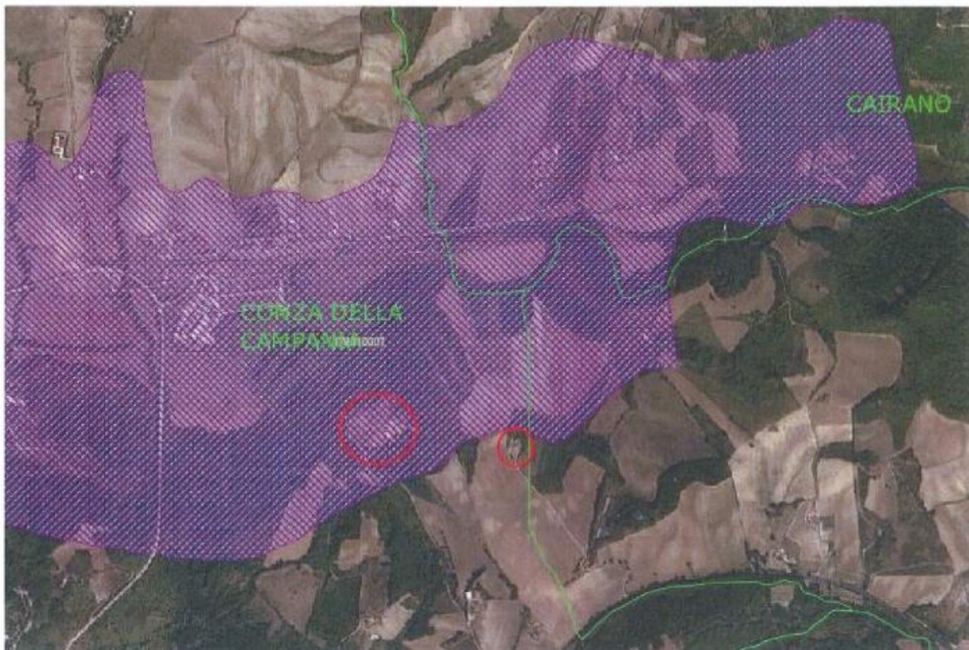
**CHE** L'intervento consiste nel colmare due sbancamenti antropici, realizzati in concomitanza con la realizzazione della diga di Conza dalla Ferrocemento S.p.A., al fine di garantire la stabilità dei luoghi preservando le scarpate laterali dal possibile innesco di fenomeni gravitativi e rendere possibile la coltivazione del fondo ottenuto.
