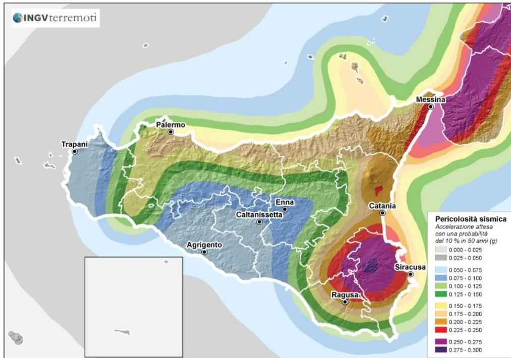
Fig. 4 Mappa della pericolosità sismica espressa in termini di accelerazione massima al suolo con probabilità di eccedenza del 10% in 50 anni riferita a suoli rigidi ( $V_s > 800$  m/s), Ordinanza PCM del 28 aprile 2006 n. 3519, All.1b; estratta da: <http://zonesismiche.mi.ingv.it>
