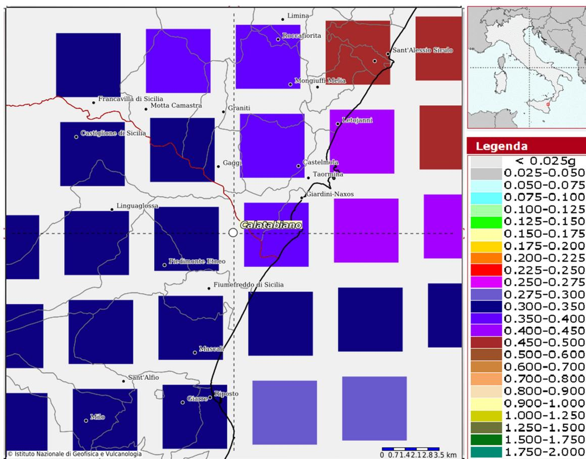
Figura 6 – Es. griglia di pericolosità sismica per il sito (Lat. 37.732 – Long. 15. 204) con probabilità in 50 anni al 2% e percentile al 50
