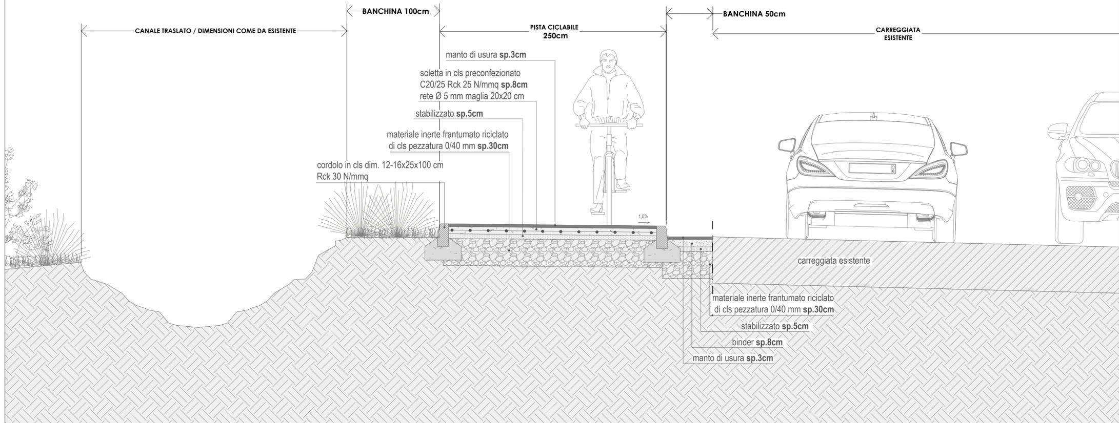
Stato di Progetto - Sezione B-B
