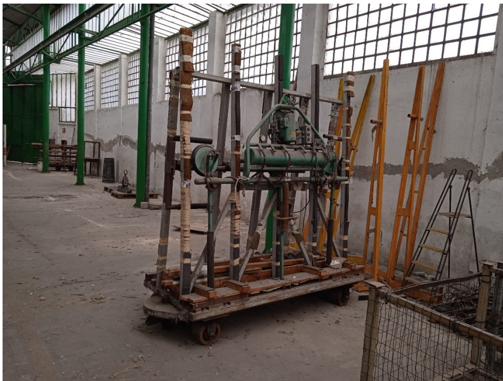
Figura 2 – Macchinario per il trasporto delle lastre di vetro
