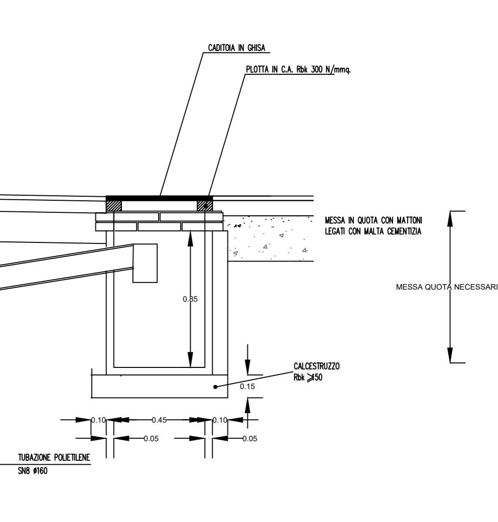
PARTICOLARE POZZETTO D'ISPEZIONE FOGNATURA ACQUE BIANCHE
