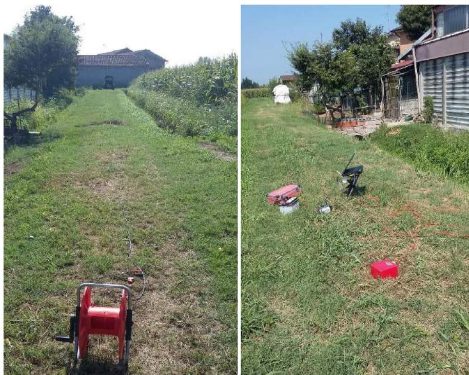
Figura 3. Stendimento sismico (a sinistra) e acquisizione HVSR (a destra).
