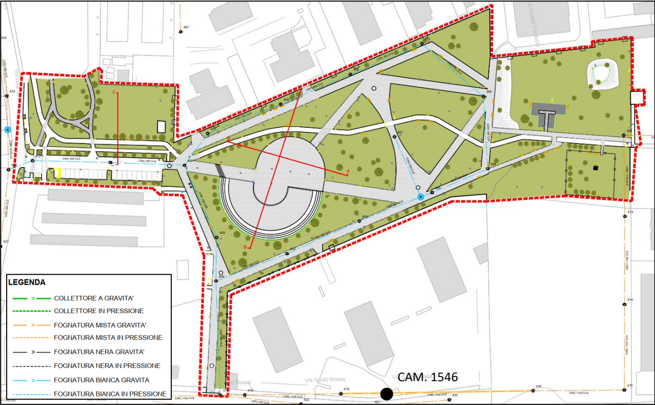
Figura 4 – Rete di drenaggio in stato di fatto
