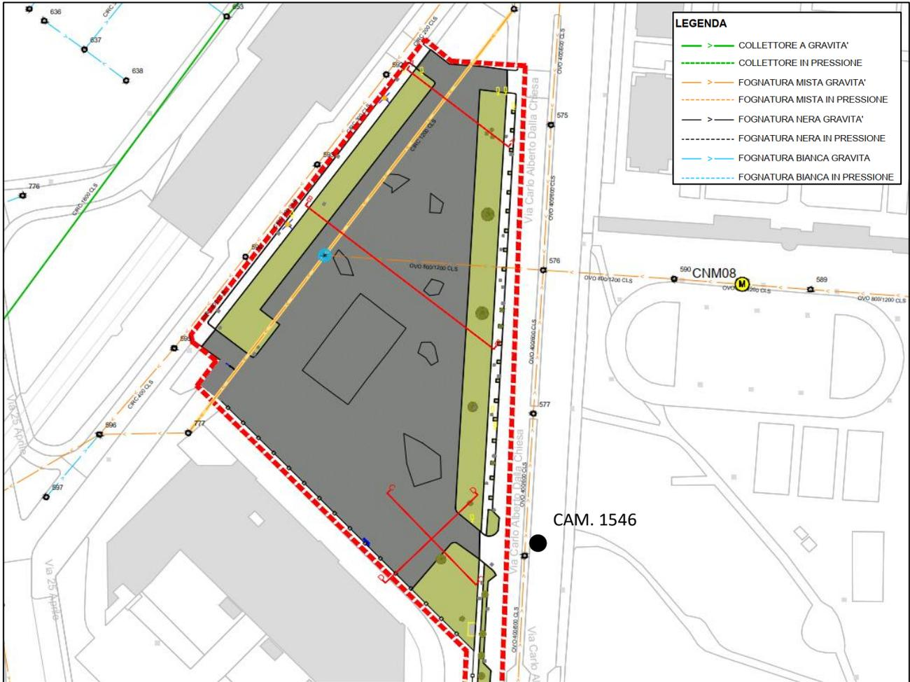
Figura 3 – Rete di drenaggio in stato di fatto
