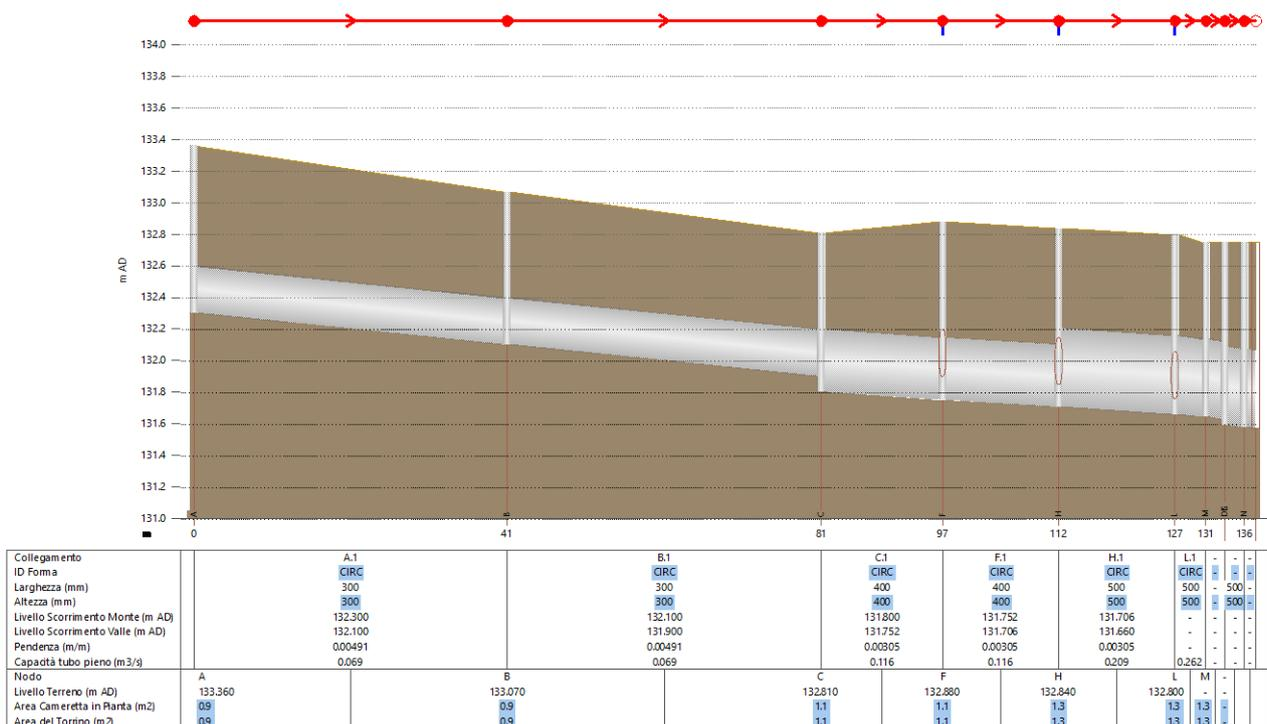
Figura 4 – Profilo nuova rete acque meteoriche del parcheggio in esame
