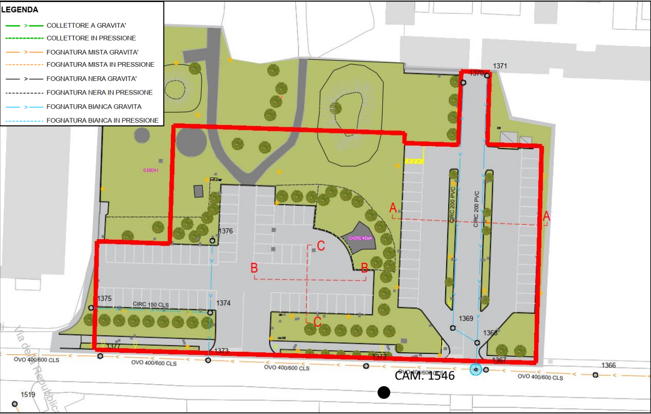
Figura 4 – Rete di drenaggio in stato di fatto
