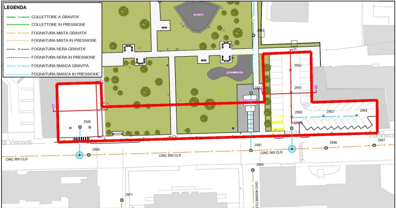
Figura 4 – Rete di drenaggio in stato di fatto
