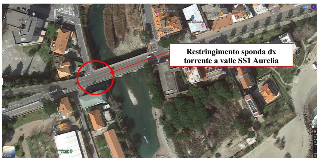
Fig. 6. Foto satellitare tratto torrente a ridosso del ponte SS1 Aurelia
