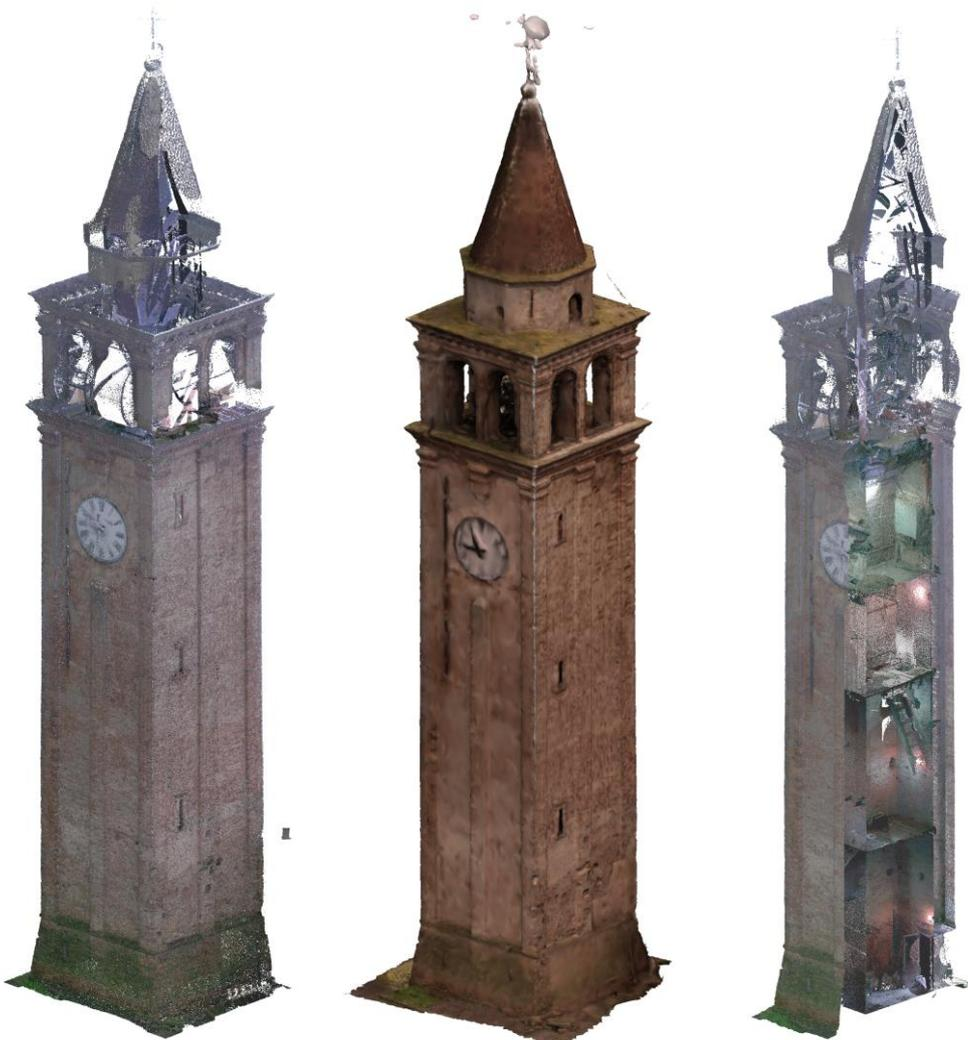
Il rilievo geometrico è stato eseguito mediante tecnologia laser scanner e topografia tradizionale, tale rilievo ha permesso l'ottenimento di dati di elevato valore tecnologico, e di rappresentare l'edificio attraverso la restituzione di un modello tridimensionale a punti georiferiti fino ad arrivare alla rappresentazione in pianta, sezione e prospetto in formato vettoriale.
