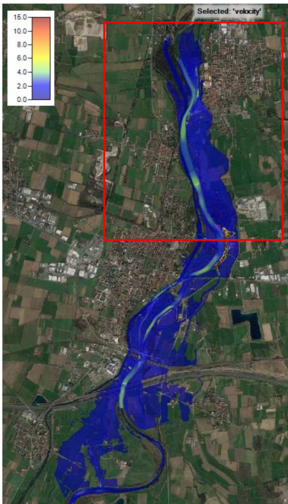
Figura – Planimetria delle velocità (nelle condizioni più gravose) per TR=200 anni – Studio Geologico di Cassano d'Adda - 2019
