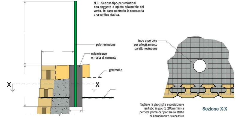
Sezione recinzioni e parapetti su muratura armata di contenimento tipo
