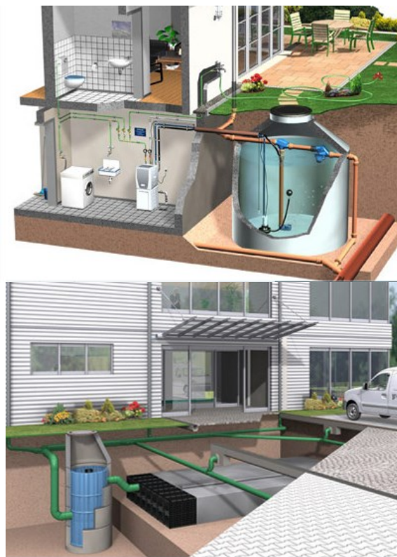
Figura 22 – Esempi di applicazione di vasche di laminazione sotterranee per piccole e medie estensioni, strutturabili sia per la sola laminazione con scarico in sistema di infiltrazione, sia per il riuso (tratte dal sito http://www.3ptechnik.it/it/home.html )
