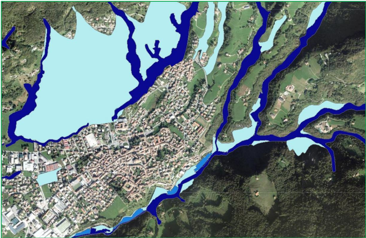
Figura 7 - Perimetrazioni di pericolosità idraulica del P.G.R.A. 2022 su Gandino
