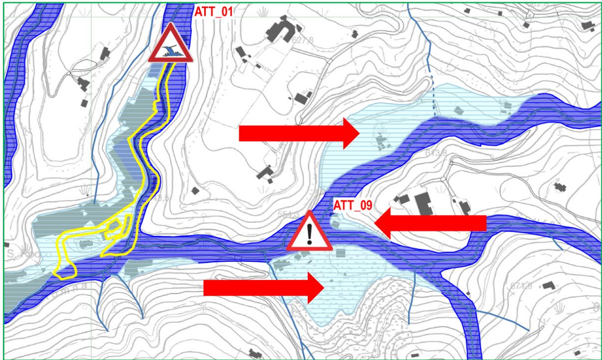
Figura 23 - Aree a pericolosità moderata di esondazione derivanti dal P.G.T. e dal P.G.R.A. in bassa Val Piana, località Prat Servà e Masne (indicate dalle frecce rosse)
