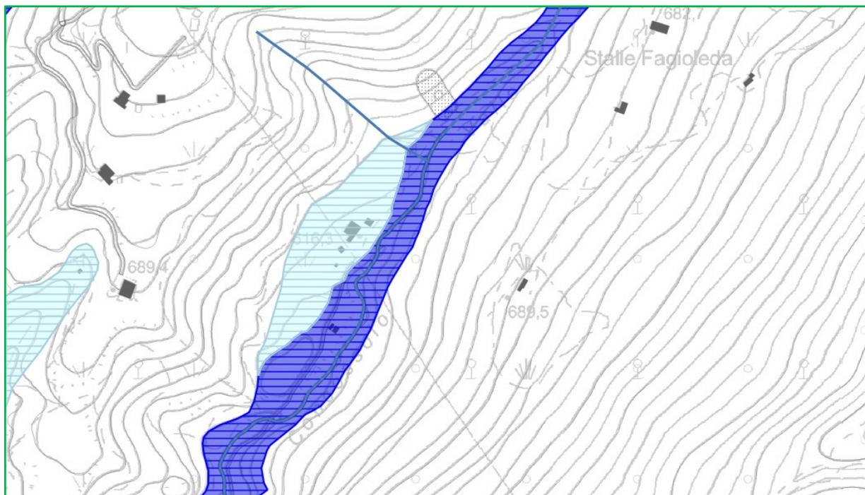
Figura 10 - Aree a pericolosità di esondazione in località Concozzola / Laghetto Corrado
