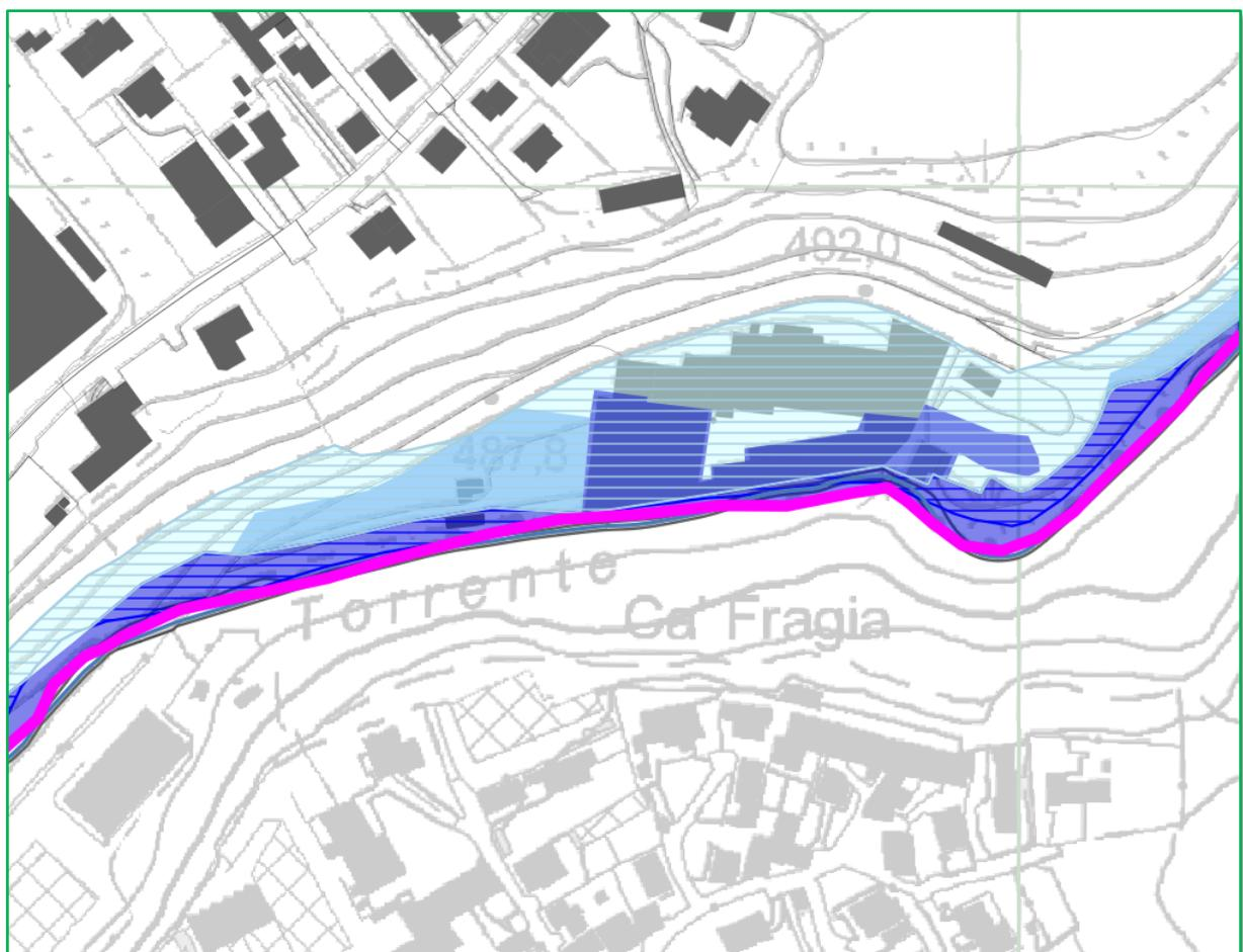
Figura 20 - Aree di rischio idraulico lungo il Torrente Romna in corrispondenza del Lanificio Torri
