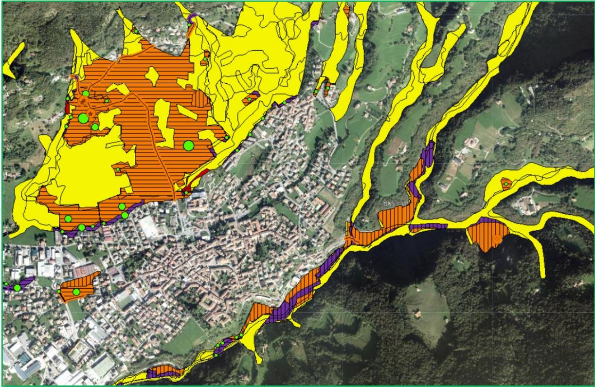
Figura 8 - Perimetrazioni di rischio idraulico del P.G.R.A. 2022 su Gandino; le aree di rischio R4 sono tracciate in viola, e sono concentrate per lo più entro il Torrente Re, il Torrente Romna ed il Torrente Concozzola
