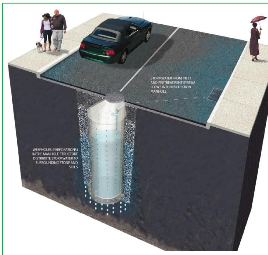
Figura 141 - Esempio di utilizzo di pozzi disperdenti per le acque meteoriche direttamente al di sotto della sede stradale
