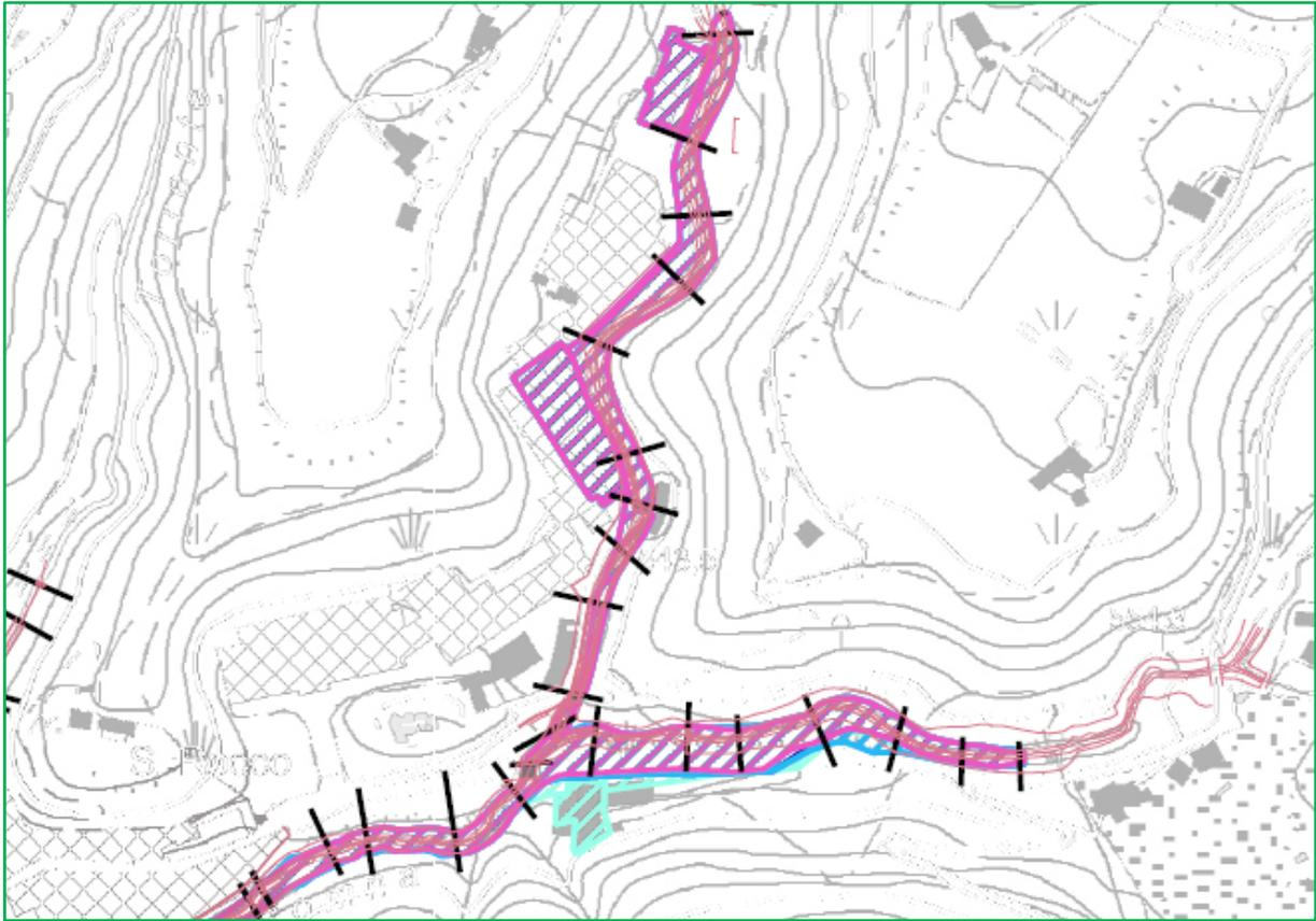
Figura 16 - Stralcio dello studio di dettaglio 2017 con indicata l'area esondativa della Concozzola; il tempo di ritorno indicato è di 20 anni con interessamento di alcuni capannoni
