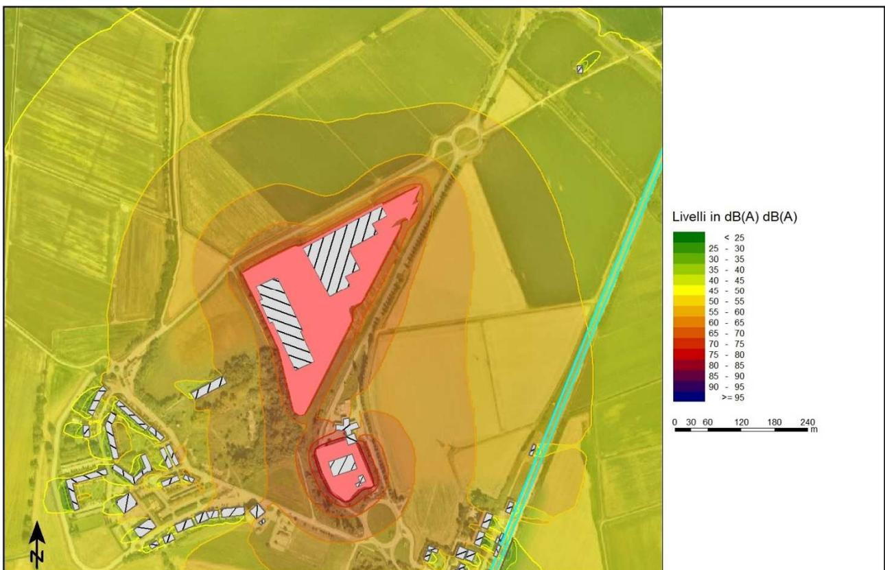
Figura 17 - Mappa della propagazione del rumore nel periodo diurno, calcolata a 2 m di altezza.
