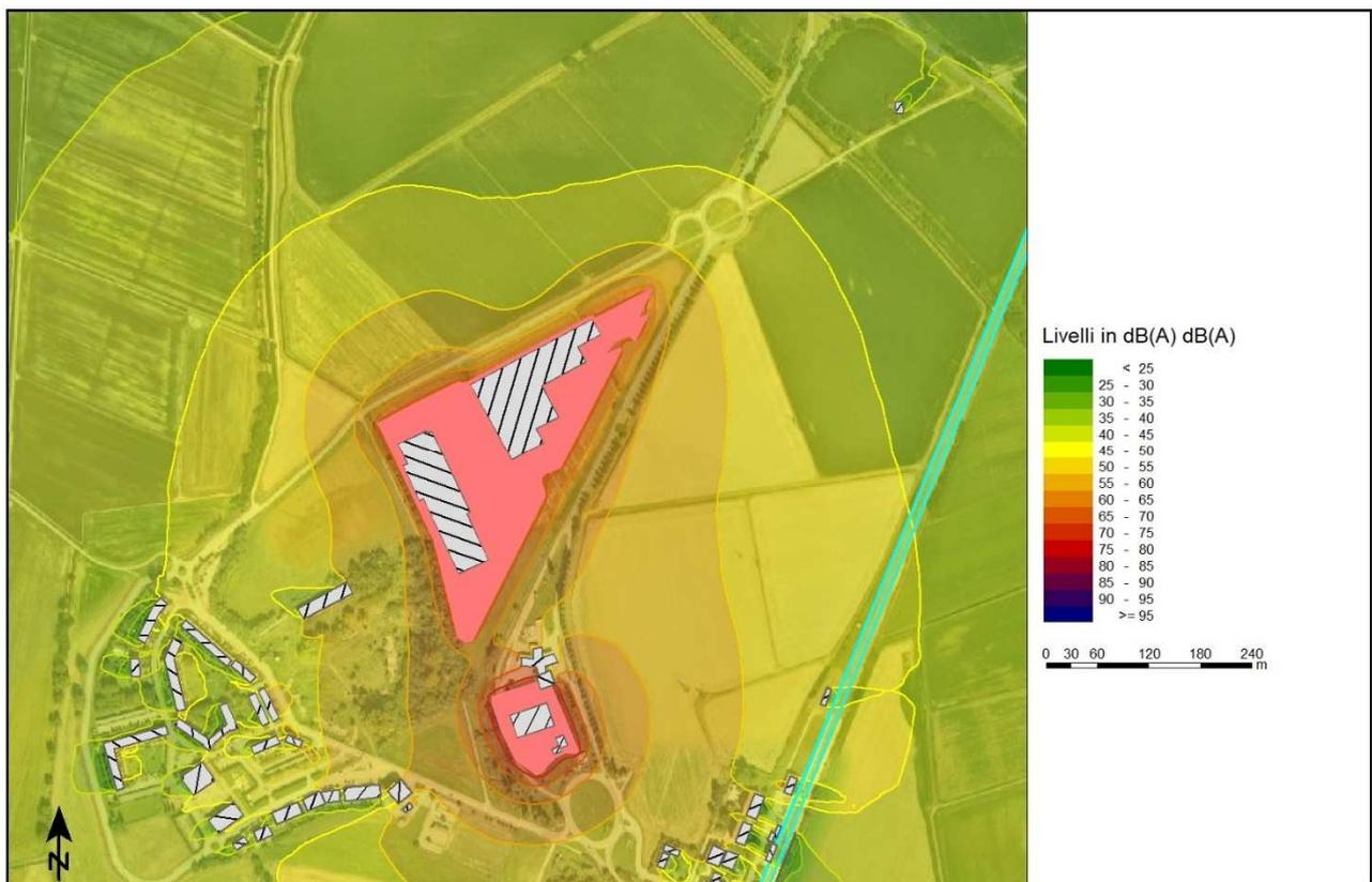
Figura 21 - Mappa della propagazione del rumore nel periodo diurno, calcolata a 2 m di altezza.
