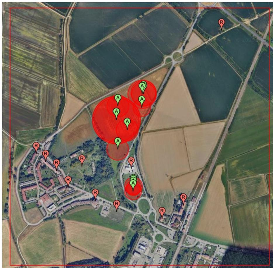
Figura 10- Dominio di calcolo, sorgenti emissive (A) e ricettori (R) modellizzati nel software WinDimula.
