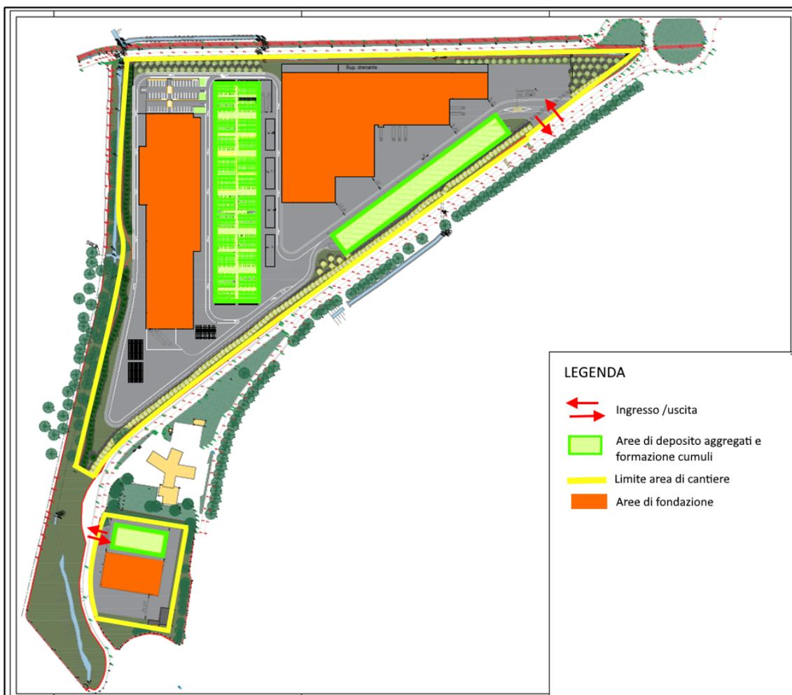
Figura 3 – Layout di cantiere.
