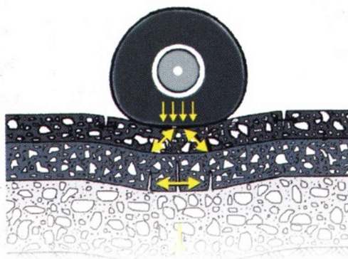
Figura 28 – Effetti del carico da traffico
