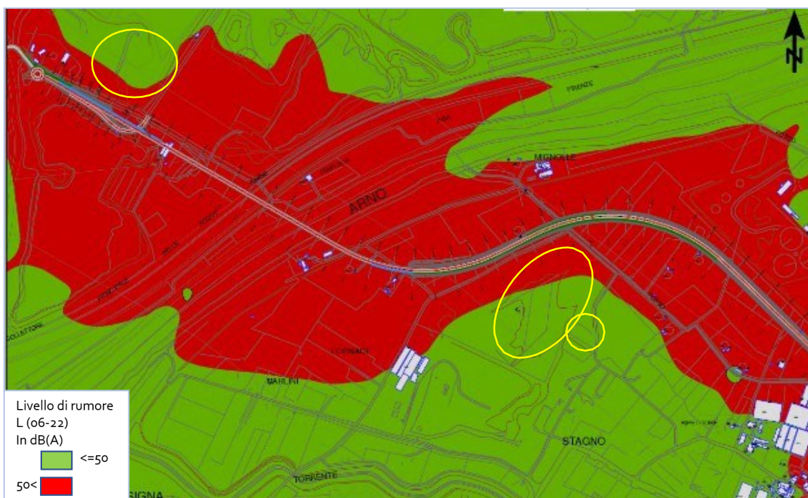
Figura 9.11 - Mappa acustica stato di progetto con mitigazioni - Periodo notturno
