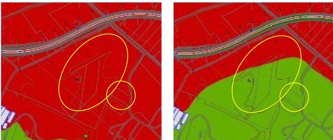
Figura 9.13 – Raffronto mappa acustica stato di progetto senza mitigazioni (sx) e con mitigazioni (dx)
