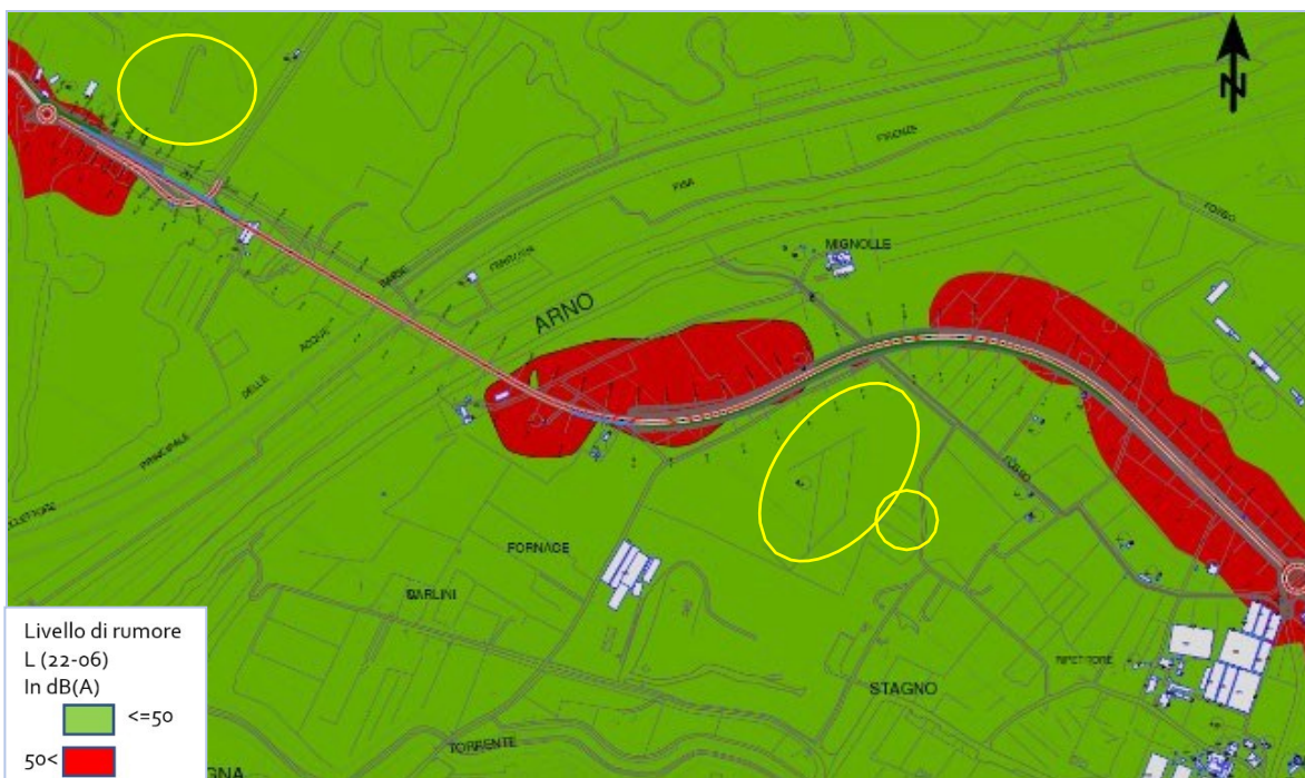
Figura 9.11 - Mappa acustica stato di progetto con mitigazioni - Periodo notturno
