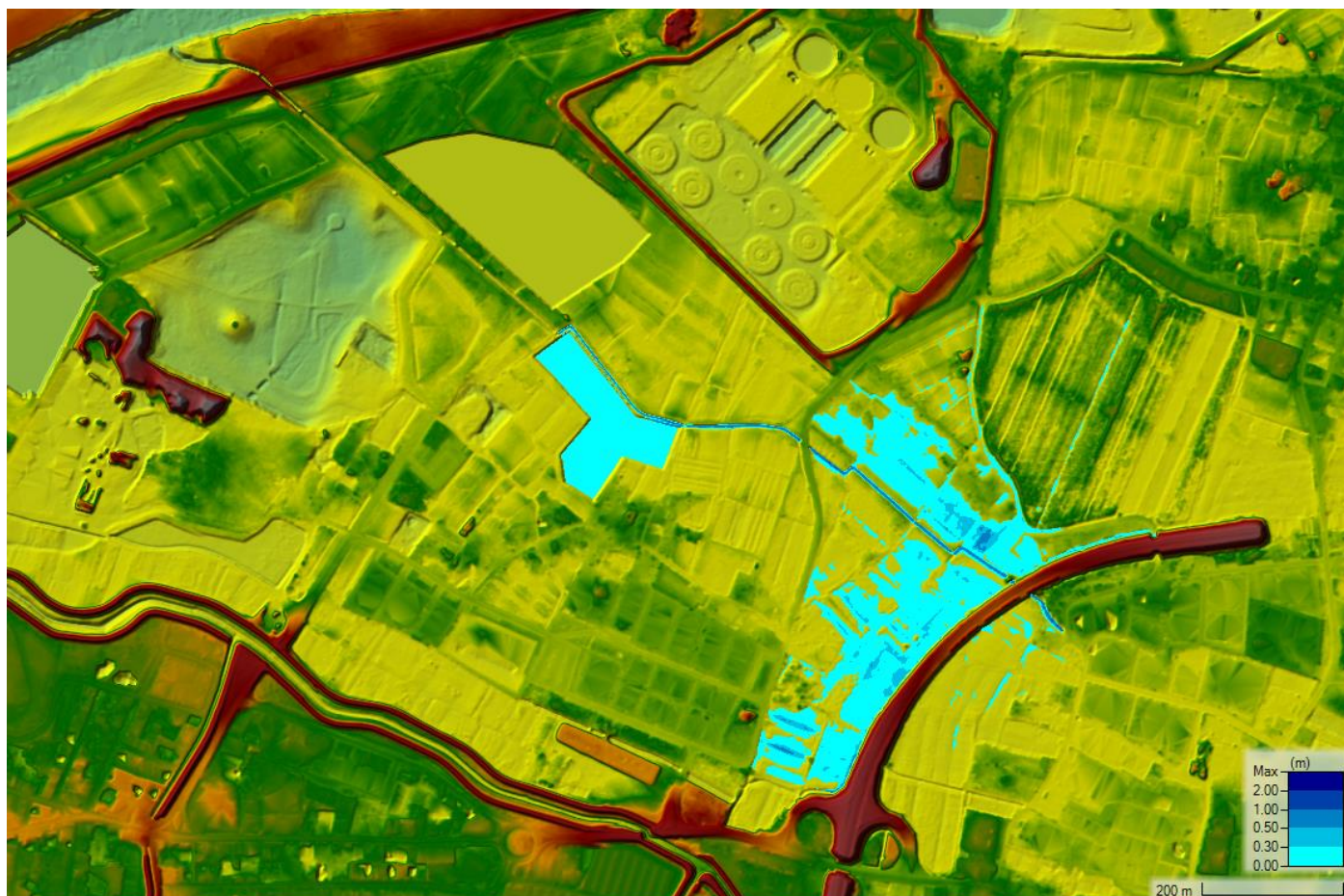
Fig. SA Tr200d01 inviluppo max. altezze d'acqua
