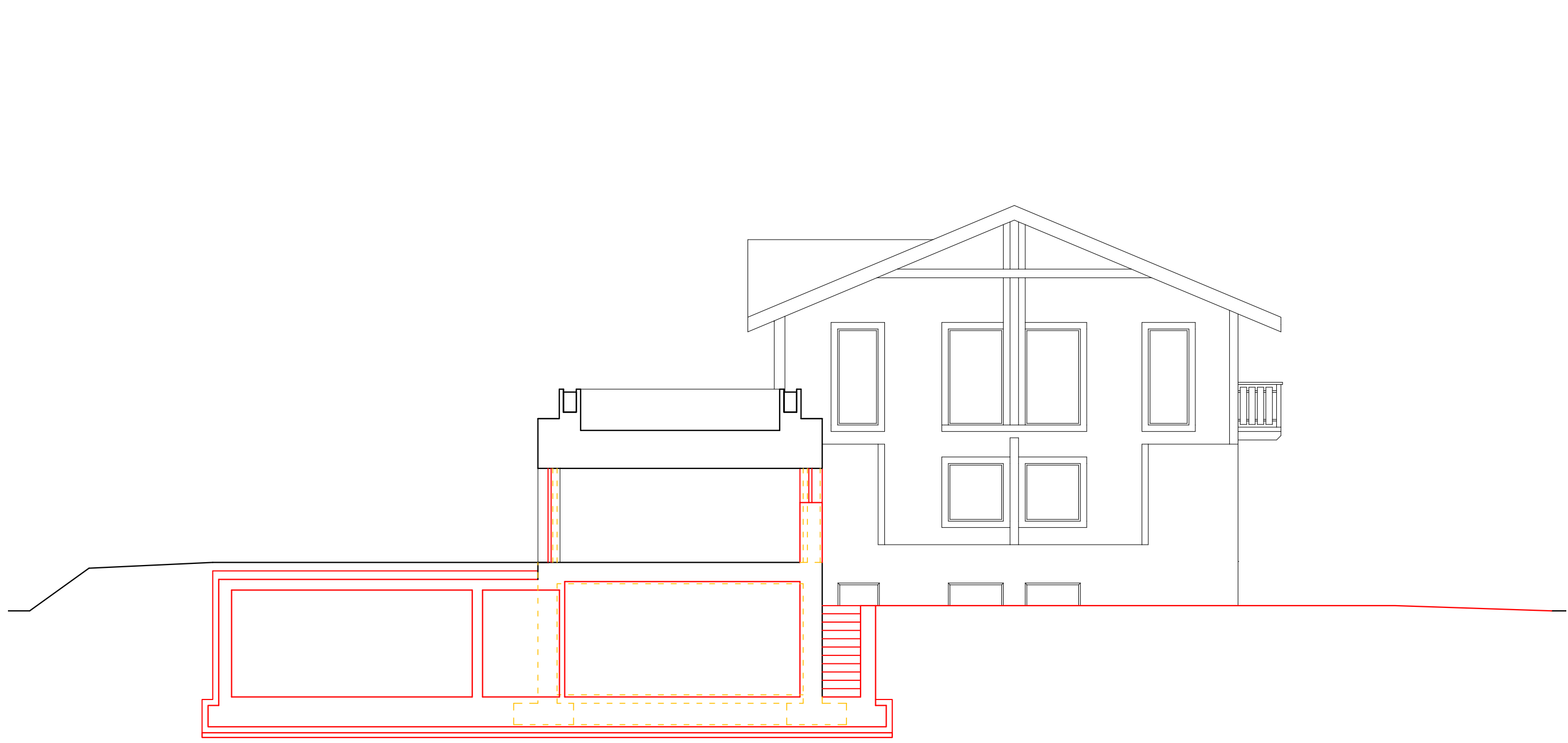
COMPARAZIONE PROSPETTO SUD ABITAZIONE-SEZIONE F-F
