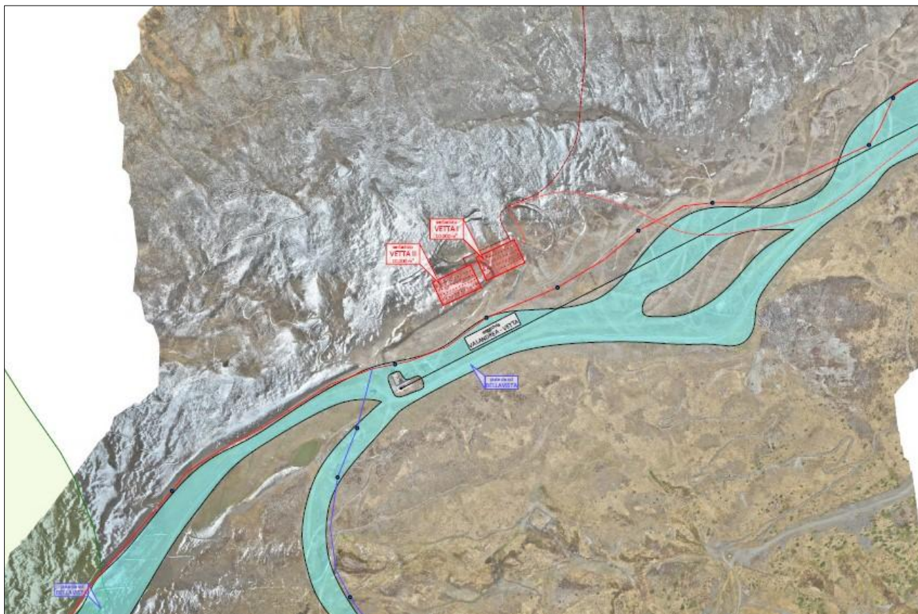
Ipotesi progettuali considerate: IPOTESI 4 relativa alla realizzazione di due vasche interrate in c.a.
