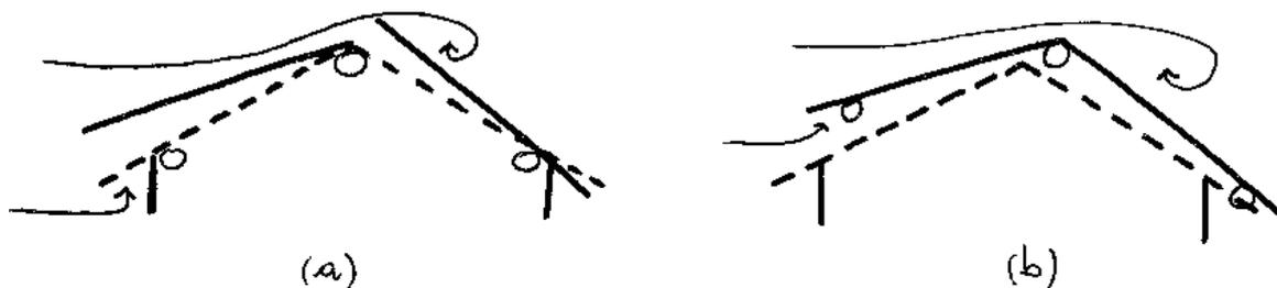
Figura 6.1.: Modalità di rottura di una copertura sotto l'azione di valanga: (a) sollevamento delle falde sopravvento e sottovento, (b) sollevamento totale della copertura.
