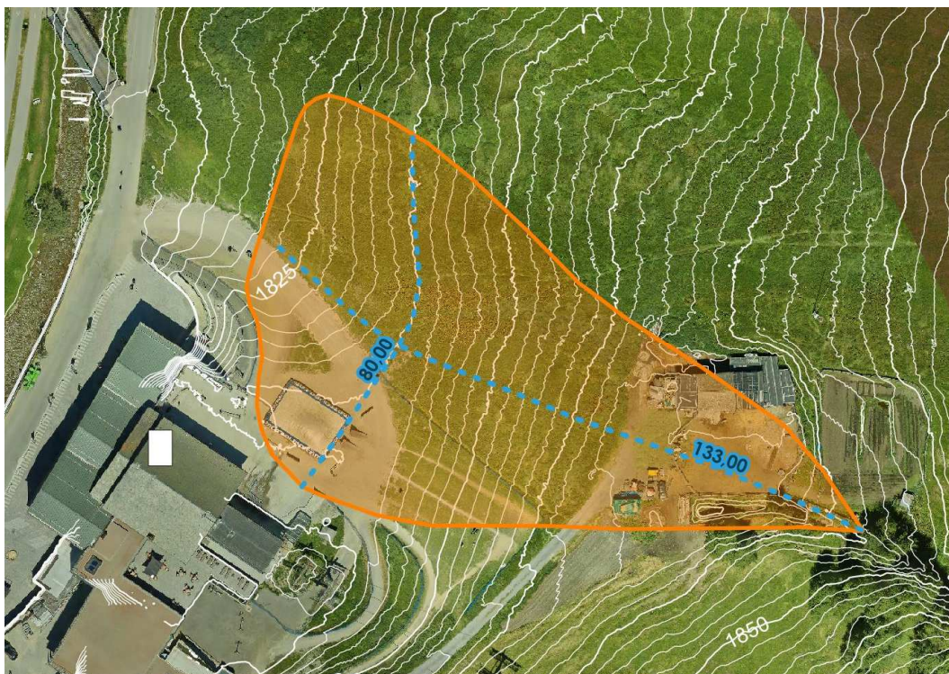
Figura 5.1: Area di espansione della colata
