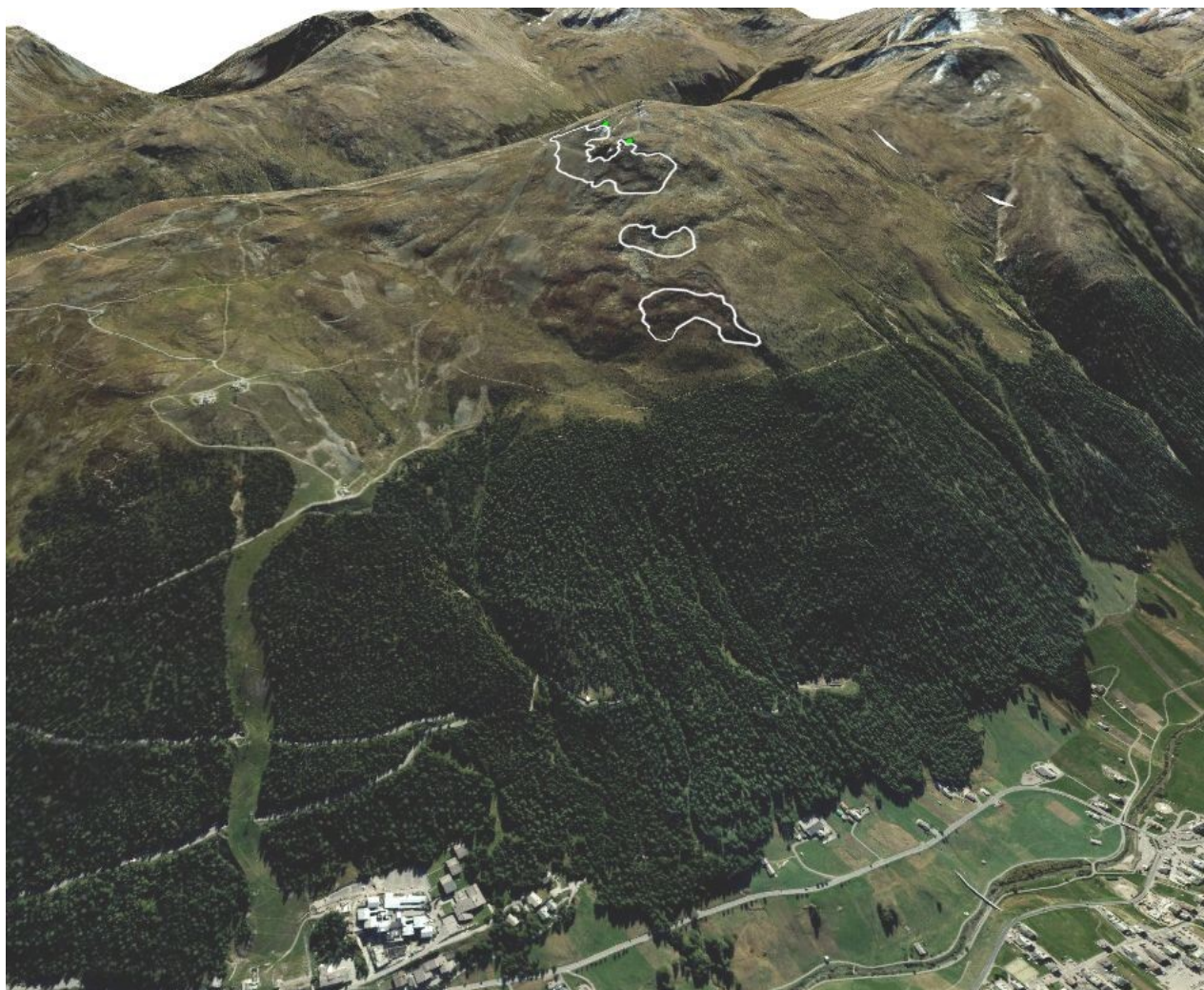
Figura 61: vista in 3D del sito valanghivo con evidenziate le zone potenziali di distacco e le eventuali opere di protezione, come base cartografica è stata utilizzata l'ortofoto della Regione Lombardia del 2018.
