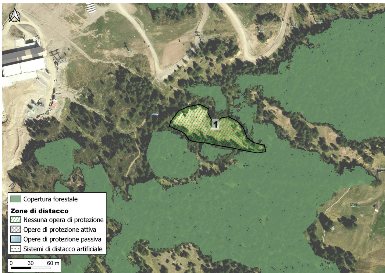
Figura 15: rappresentazione dell'area di distacco, suddivisa in funzione delle opere di protezione.
