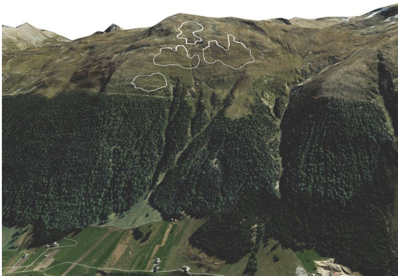
Figura 53: vista in 3D del sito valanghivo con evidenziate le zone potenziali di distacco e le eventuali opere di protezione, come base cartografica è stata utilizzata l'ortofoto della Regione Lombardia del 2018.
