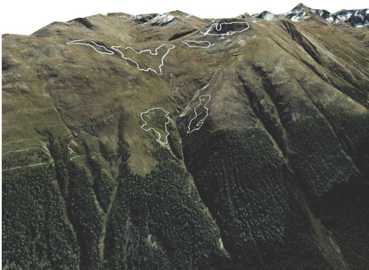
Figura 45: vista in 3D del sito valanghivo con evidenziate le zone potenziali di distacco e le eventuali opere di protezione, come base cartografica è stata utilizzata l'ortofoto della Regione Lombardia del 2018.
