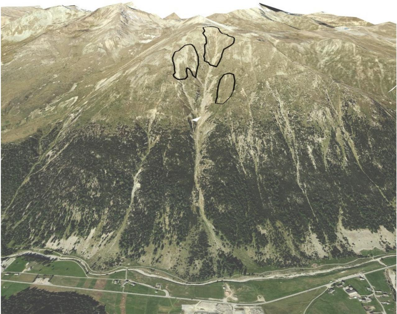
*Figura 22: vista in 3D del sito valanghivo con evidenziate le zone potenziali di distacco e le eventuali opere di protezione, come base cartografica si è utilizzata l'ortofoto della Regione Lombardia del 2018.*
