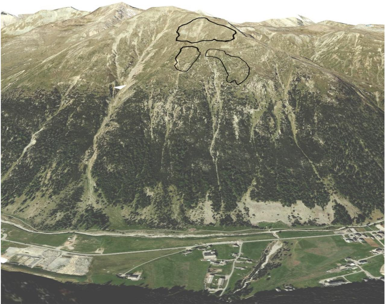
*Figura 11: vista in 3D del sito valanghivo con evidenziate le zone potenziali di distacco e le eventuali opere di protezione, come base cartografica si è utilizzata l'ortofoto della Regione Lombardia del 2018.*
