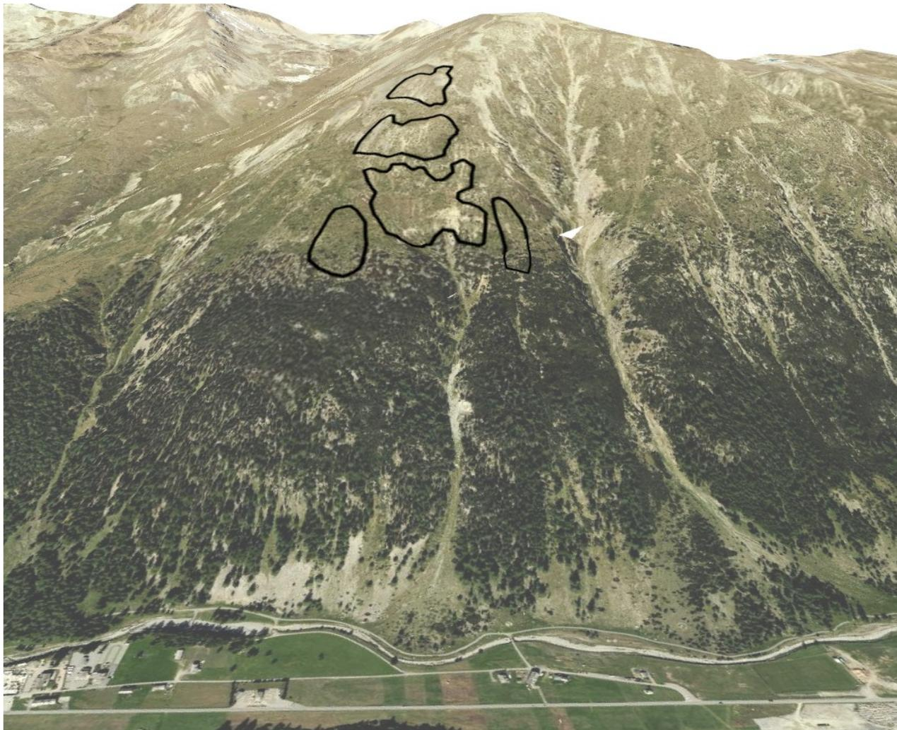
*Figura 31: vista in 3D del sito valanghivo con evidenziate le zone potenziali di distacco e le eventuali opere di protezione, come base cartografica si è utilizzata l'ortofoto della Regione Lombardia del 2018.*
