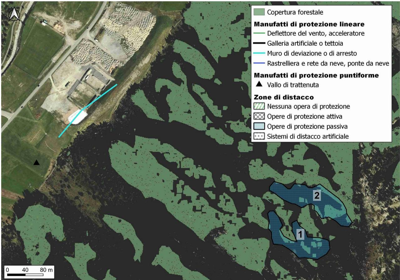
Figura 100: rappresentazione delle aree di distacco, suddivise in funzione delle opere di protezione, sito 398.
