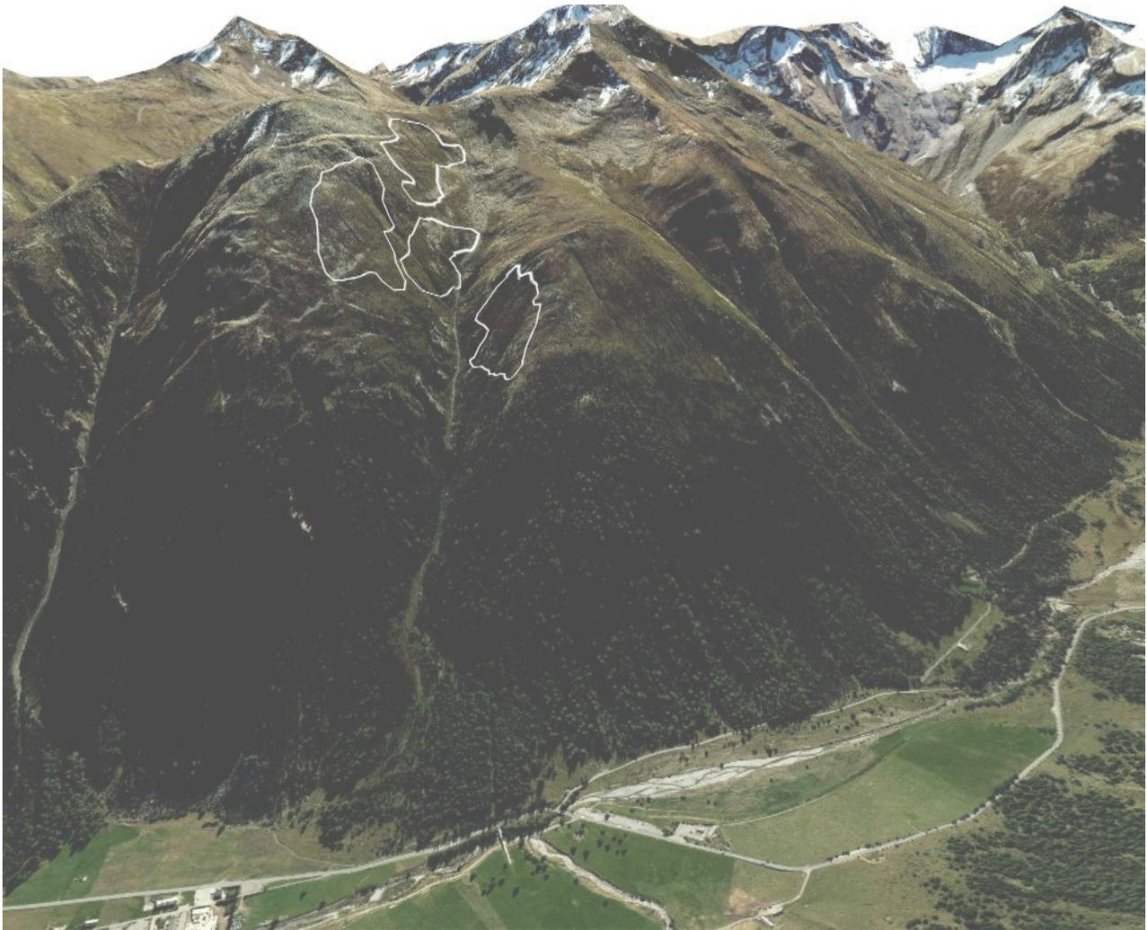
*Figura 52: vista in 3D del sito valanghivo con evidenziate le zone potenziali di distacco e le eventuali opere di protezione, come base cartografica si è utilizzata l'ortofoto della Regione Lombardia del 2018.*
