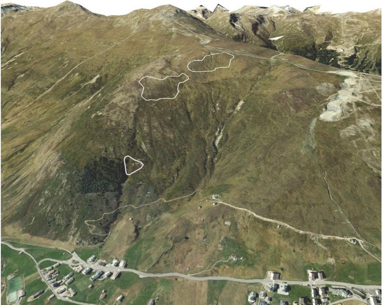
*Figura 8: vista in 3D del sito valanghivo con evidenziate le zone potenziali di distacco e le eventuali opere di protezione, come base cartografica si è utilizzata l'ortofoto della Regione Lombardia del 2018.*
