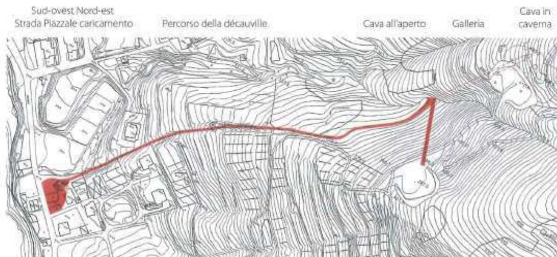
Figura 1.34 – Carta topografica rappresentante la struttura delle Buse di Gavarno. Si nota che il sito di coltivazione, a destra, è posizionato sulla Collina di Villa di Serio, collegata all'impianto di lavorazione mediante décauville, il cui percorso è segnato in rosso. Immagine presa da Natura e Luoghi da Gavarno a Lonno, Carlo Marconi, 2005.
