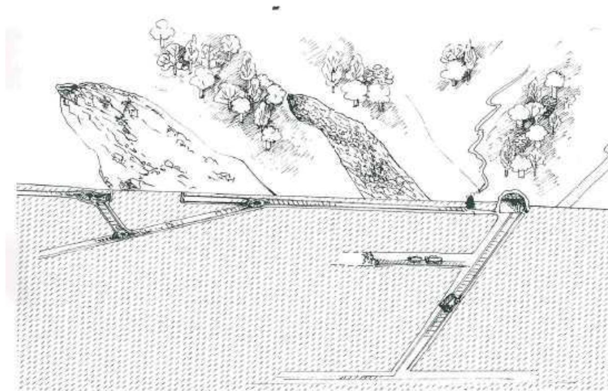
Figura 1.42 – Sezione orientativa delle parti iniziali delle cave Bonorandi. Illustrazione di Silvana Gamba, in base alle informazioni fornite da Daniele Mutti e Gianni Comotti. Immagine presa da Natura e Luoghi da Gavarno a Lonno, Carlo Marconi, 2005.
