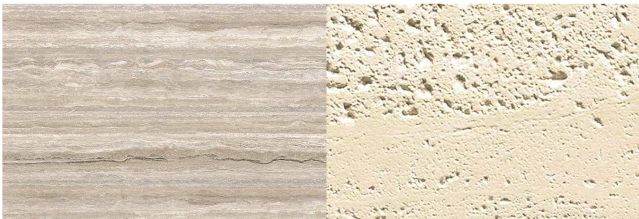
Figura 1.8 - Due diverse tipologie di travertino. L'immagine a destra mostra una roccia decisamente più porosa, quella a sinistra mostra invece una migliore stratificazione dovuta a variazioni cromatiche, verosimilmente legate a differenze composizionali. Immagini prese da [www.irisfmg.it](http://www.irisfmg.it) e [www.caesar.it](http://www.caesar.it).
