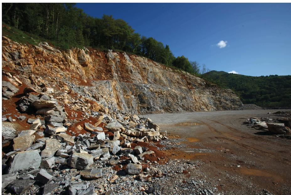
Figura 1.53 – Vista dall'interno della cava Cugini. Il colore rossastro è legato a un processo di alterazione accelerato, ovvero l'aggiunta di sostanze che facilitano l'azione degli agenti atmosferici. Questo è utile per l'ammortamento sull'impatto ambientale di un sito di coltivazione a cielo aperto. Fotografia di Cugini SpA.
