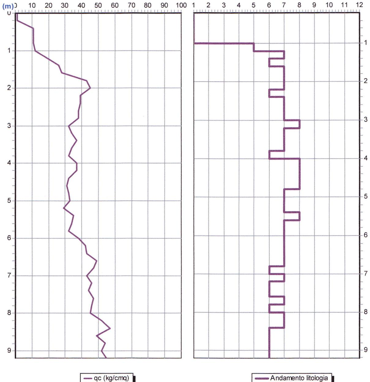
SCHMERTMANN(1978):1=Argilla organica-2=Arg.in.molto molle-3=Arg.molle-4=Arg.med.consistente-5=Arg.consistente-6=Arg.molto consistente-7=Arg.sabbiosa/limosa-8=Sabbia e limo-9=Sabbia sciolta-
