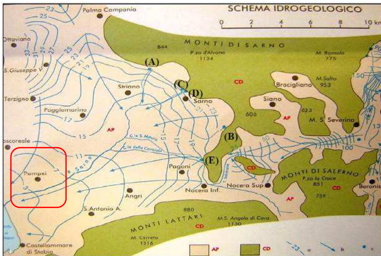
Figura 9 - Schema Idrogeologico della Piana del fiume Sarno. Legenda: (AP = Complesso alluvionale-piroclastico; CD = Complessi calcareo, calcareo dolomitico, dolomitico; (A)...(E) = Ubicazione sorgenti. Nel riquadro rosso rientra l'area di interesse.
