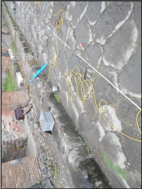
Foto Prospezione a sismica passiva HVSR.
