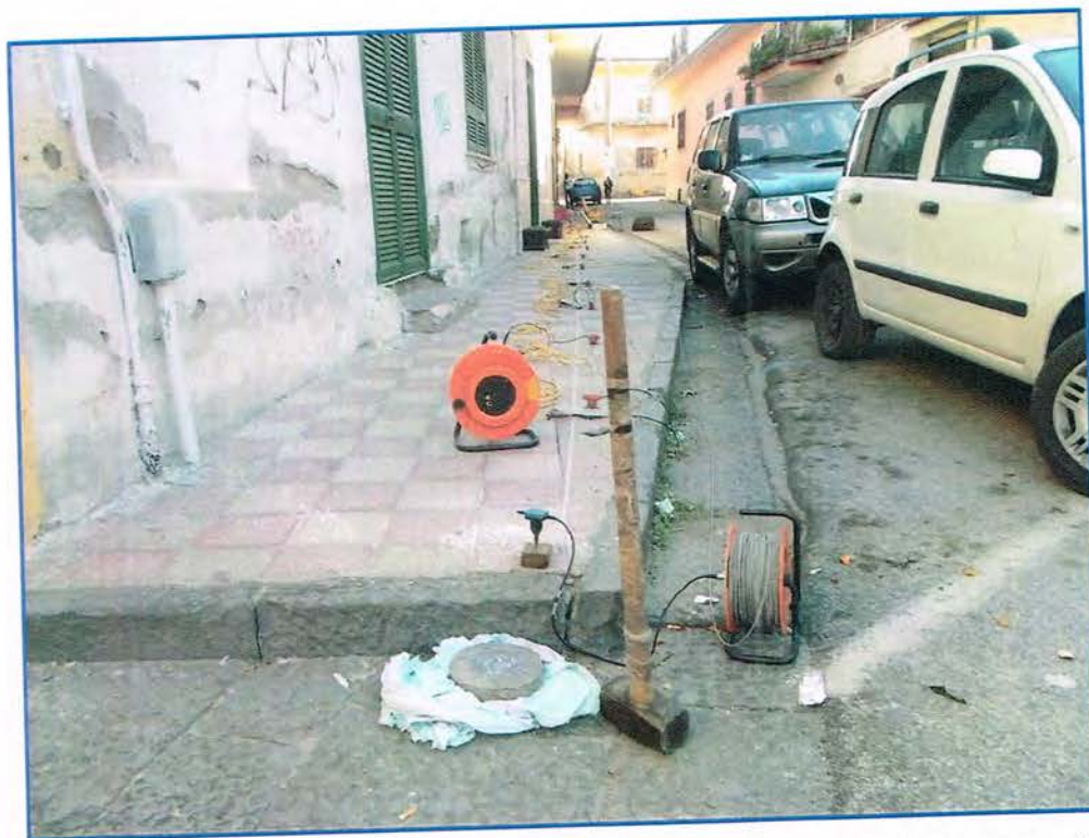
Fig. 17: Sorgente energizzante, costituita da massa battente su piastra di alluminio. Come starter/trigger è stato utilizzato un geofono verticale Geospace a 14Hz.
