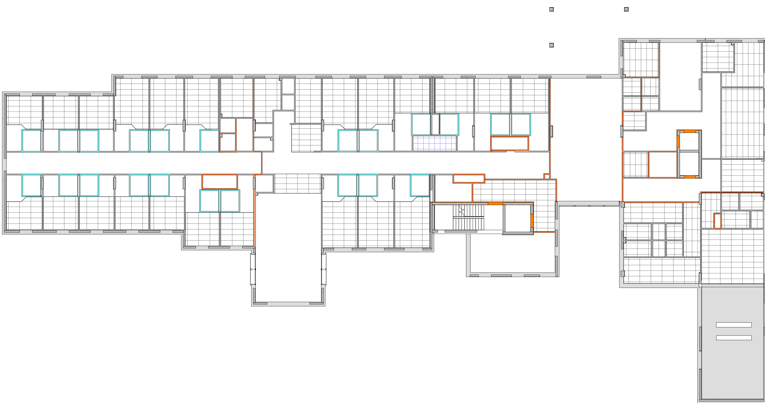
Controsoffitto Piano Primo H 2,70
