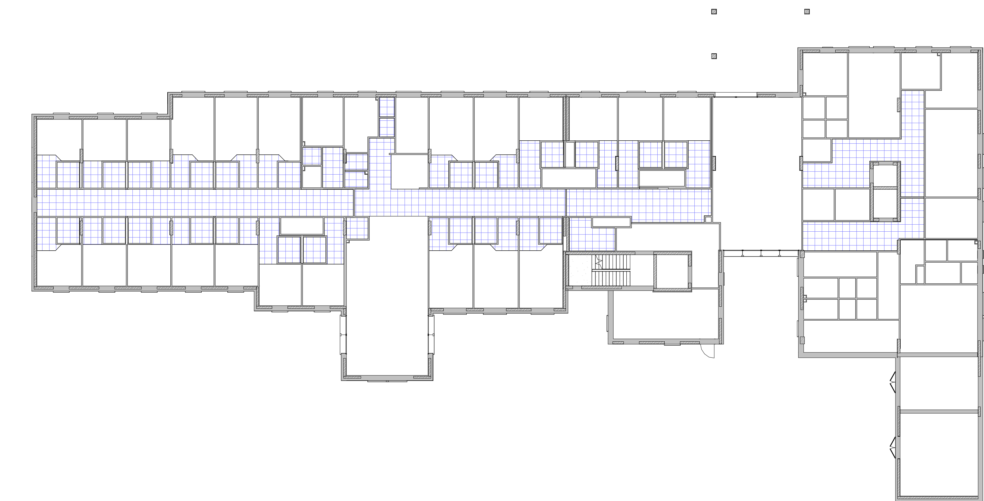
Controsoffitto Piano Primo H 2,40
