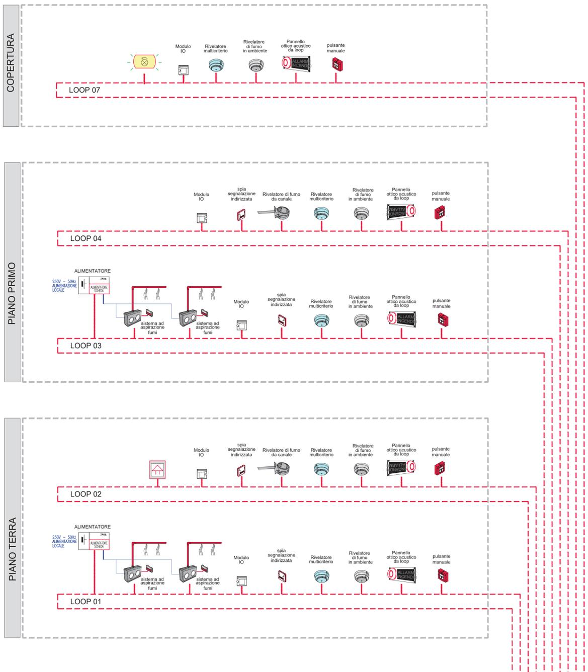
PER IL COLLEGAMENTO DI APPARATI AVENTI TENSIONI DI ESERCIZIO UGUALI O INFERIORI A 100 V c.a. (PER ESEMPIO SENSORI, PULSANTI MANUALI, INTERFACCIE, SISTEMI DI EVACUAZIONE VOCALE, AVVISATORI OTTICO-ACUSTICI, SISTEMI DI EVACUAZIONE FUMO CALORE, ECC.) SI RICHIEDE L'IMPIEGO DI CAVI RESISTENTI AL FUOCO SOTTOPOSTI A PROVA IN CONFORMITÀ ALLA CEI EN 50200.
