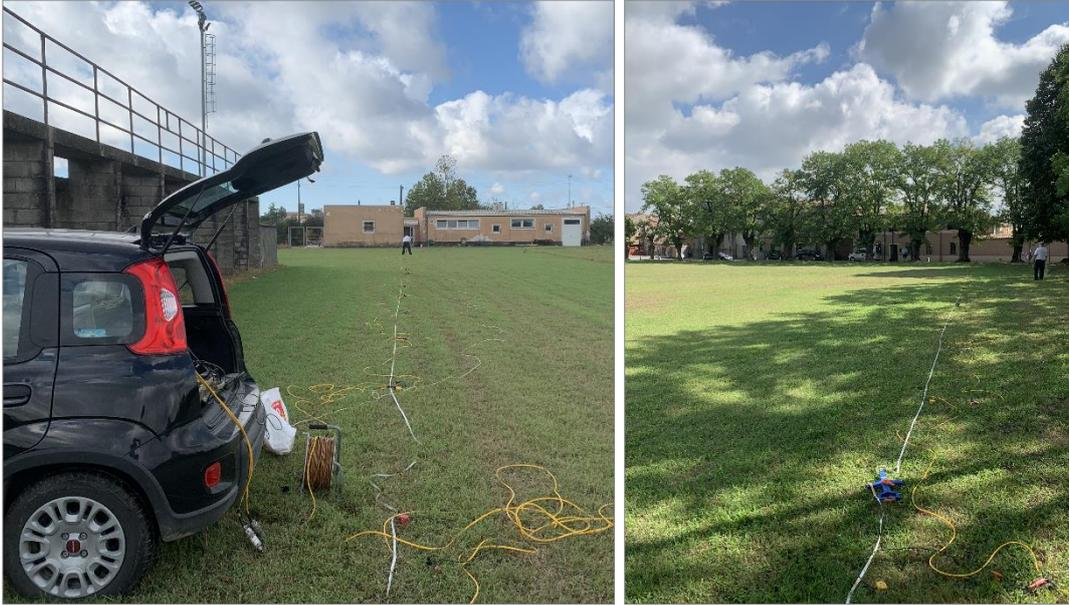
Figura 5: Prova MASW Area 1 e 2
