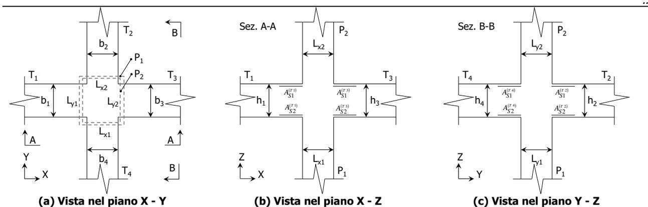
In base alle dimensioni geometriche delle membrature (travi e pilastri) concorrenti nel nodo è possibile classificare i nodi in:
