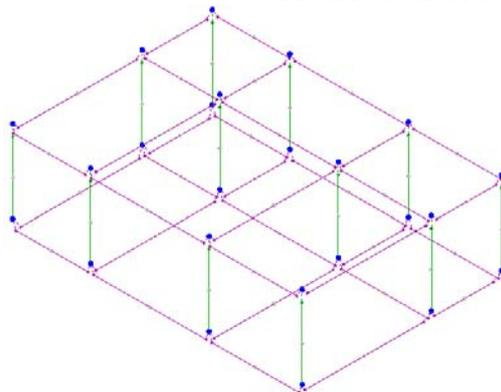
Dalle illustrazioni precedenti si evince come le aste, sia travi che pilastri, siano schematizzate con un tratto flessibile centrale e da due tratti (braccetti) rigidi alle estremità. I nodi vengono posizionati sull'asse verticale dei pilastri, in corrispondenza dell'estradosso della trave più alta che in esso si collega. Tramite i braccetti i tratti flessibili sono quindi collegati ad esso.
