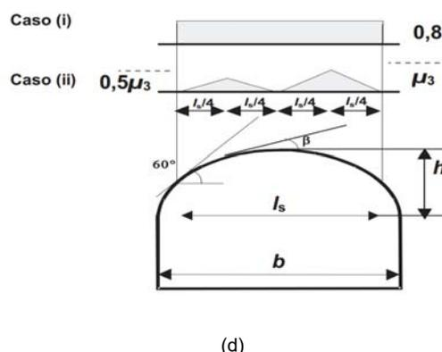
Coefficienti di forma e relative combinazioni di carico per la neve: (a) coperture ad una falda [cfr. 3.4.5.2 D.M. 2018], (b) coperture a due falde [cfr. 3.4.5.3 D.M. 2018], (c) coperture a più falde [cfr. C3.4.3.3 Circolare 2019 n. 7], (d) coperture cilindriche [cfr. C3.4.3.3.1 Circolare 2019 n. 7].
