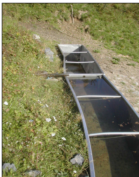
Immagine 3: vasche d'acciaio nelle vicinanze della baita di mezzo, deformate e tagliate negli spigoli; la seconda è inutilizzabile
