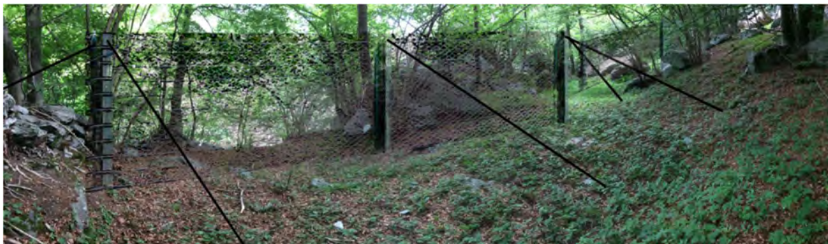
Figura 30 – Fotosimulazione della messa in posto della barriera paramassi
