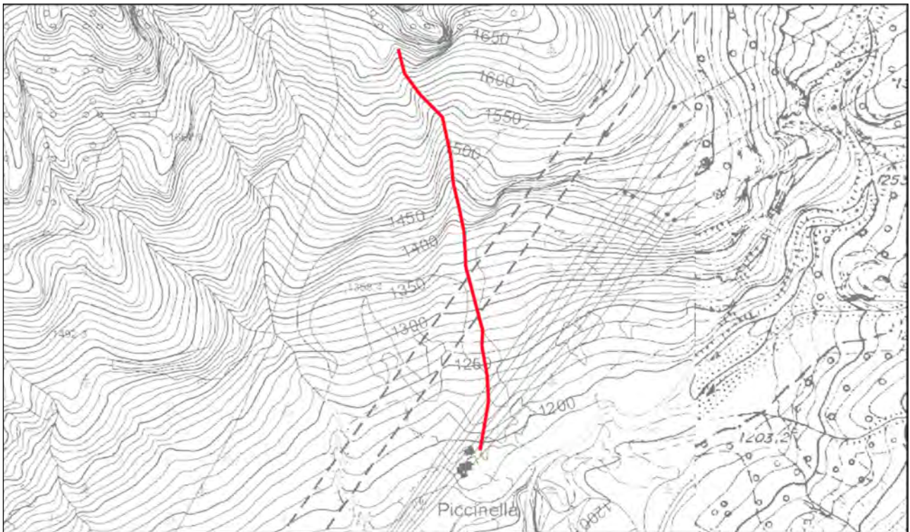
Figura 1 – Corografia dell'area di studio, cerchiata in verde la località Piccinella, in rosso indicata la traccia del profilo topografico utilizzata nell'analisi di caduta massi
