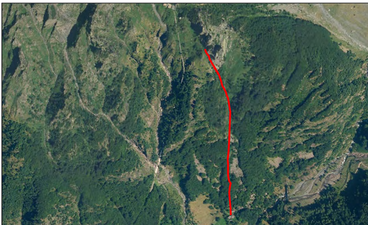
Figura 16 – Traccia in planimetria del percorso di caduta dei massi, modellizzato al fine di definire le possibili traiettorie di discesa e le relative energie.
