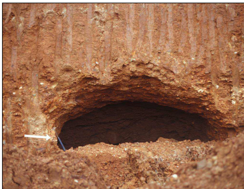
FIG. 133 Esempio di cavità in sedimenti alterati presso Bernareggio. Il martello (freccia bianca) dà la scala
