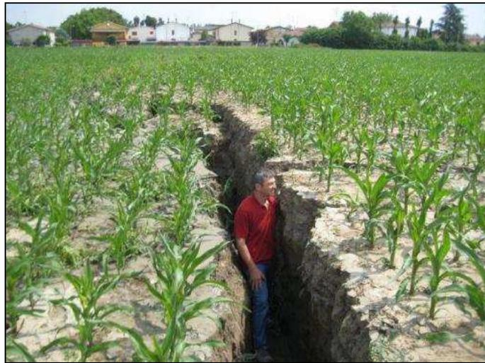
*Figura 29. Frattura nel suolo a causa di liquefazione*
