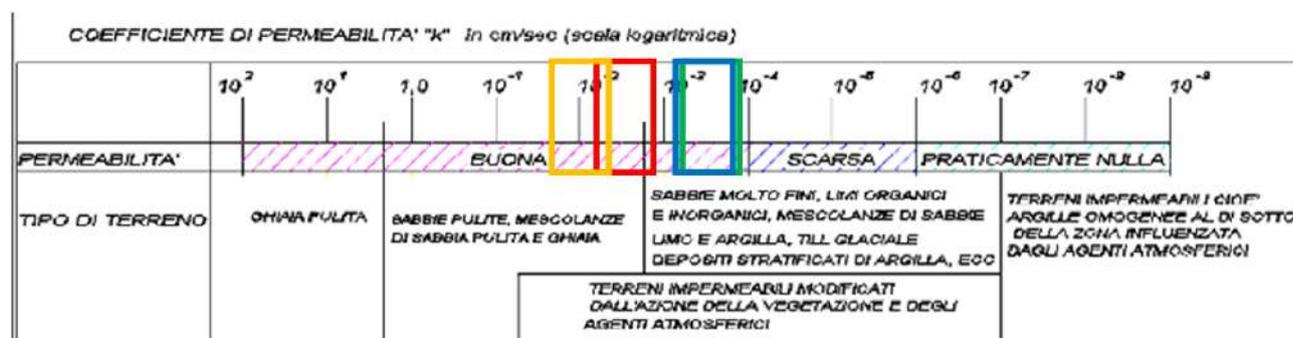
Fig. 6: Classificazione dei terreni in funzione della permeabilità
