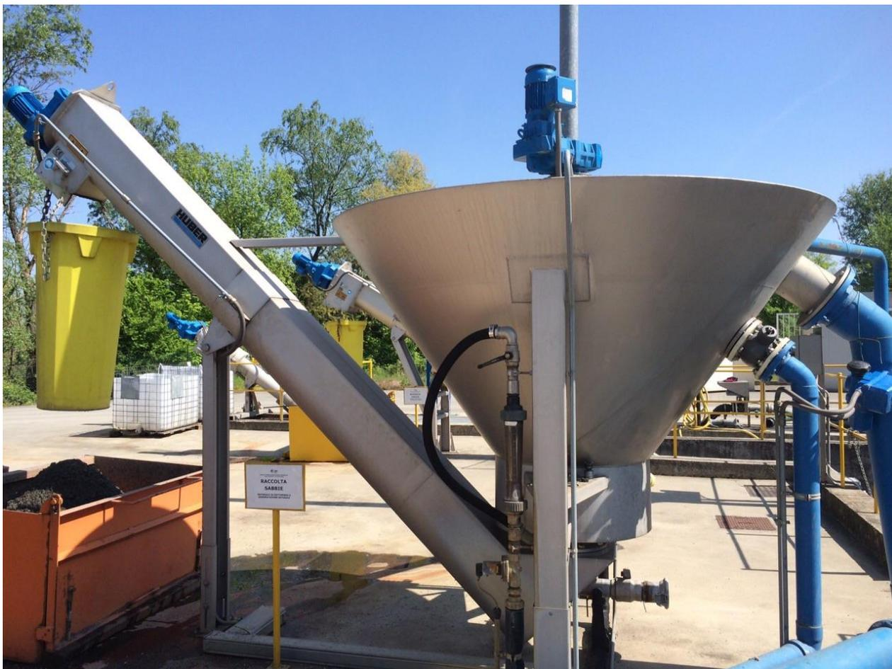
*Figura 2. Impianto di lavaggio delle sabbie (sezione comparto ricezione rifiuti "Bottini").*
